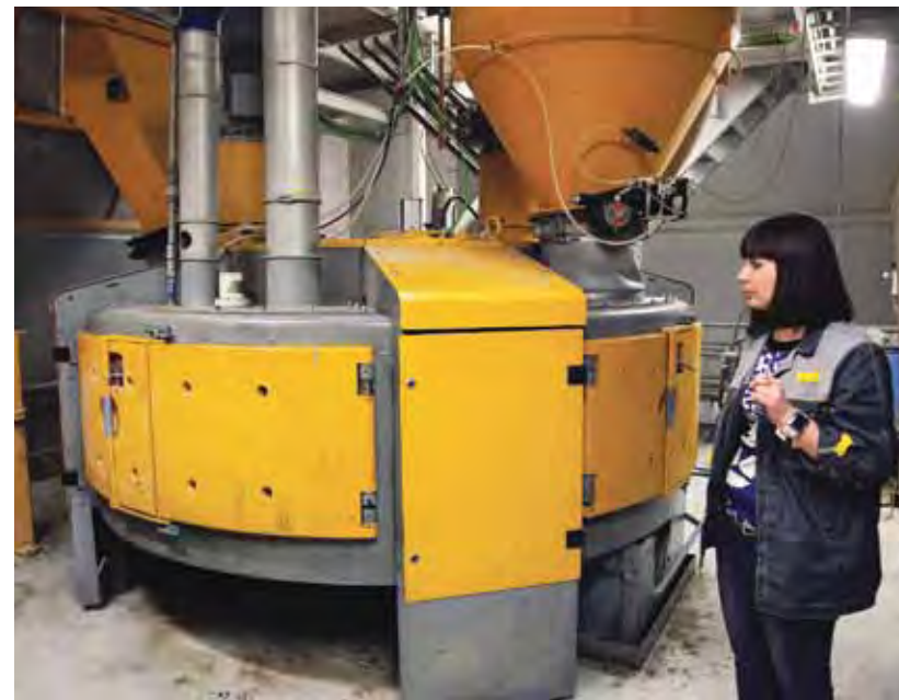
Двухкубовый двухволновый смеситель. Показывает Юлия Лопатина, начальник лаборатории
