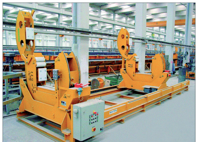
Поворотный механизм для дополнительной обработки колонн
