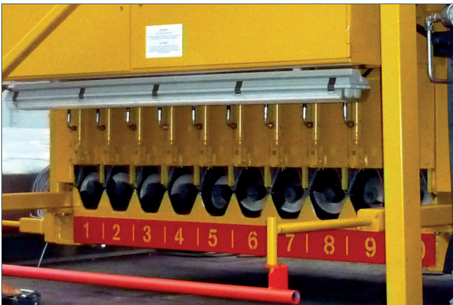
Шнековая разгрузка с индивидуальным затвором
