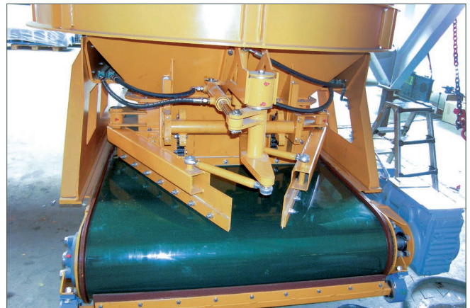
Шиберный затвор с ленточной разгрузкой
