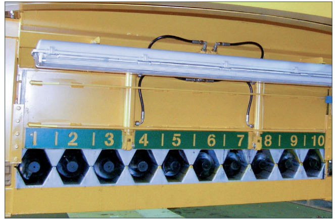
Шнековая разгрузка с центральным затвором
