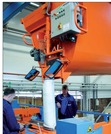
Шланговая разгрузка с шиберным затвором
