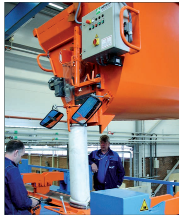
Tube de distribution avec obturbateur coulissant
