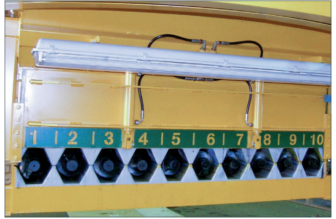
Vis sans fin avec obturbateur central
