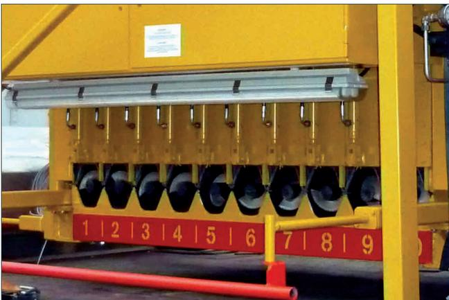
■ Schneckenaustrag mit Einzelverschluss
